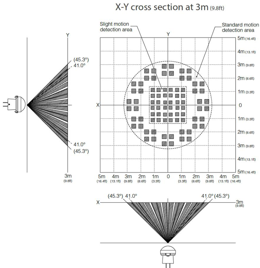
Abb. 1 Erfassungsbereich: X-Y Querschnitt bei 3m - rechteckiger Mittelbereich optimiert zur Erfassung kleinster Bewegungen (z.B. Armbewegung).
