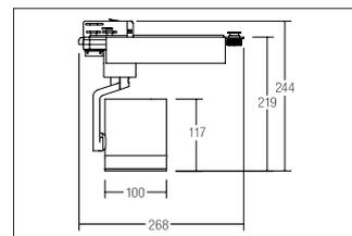
LED-Schienenstrahler CORE, schwarz. Ausführung in kompakter Bauform für die harmonische Implementierung in stimmige, architektonische Raumkonzepte.
